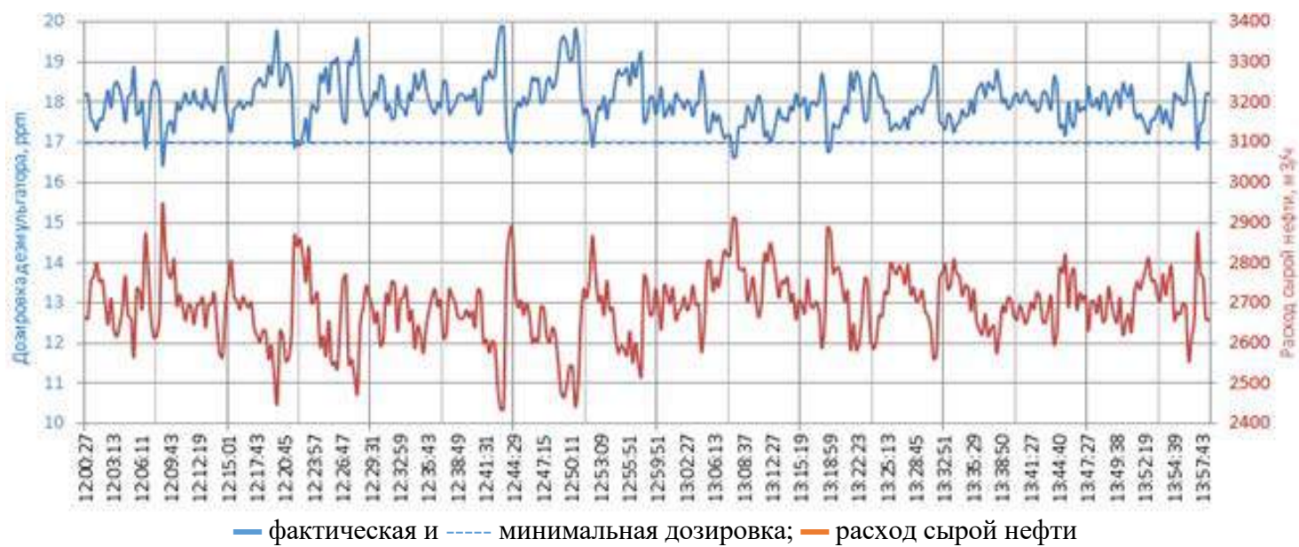
Рисунок 2 - Изменение дозировки химреагента из-за флуктуаций расхода нефти.
