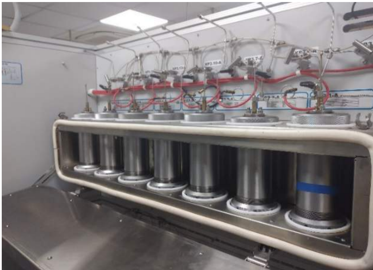
Рисунок 1 - Индивидуальные кернадержатели установки пластовой капилляриметрии, установленные в термоблоке.
