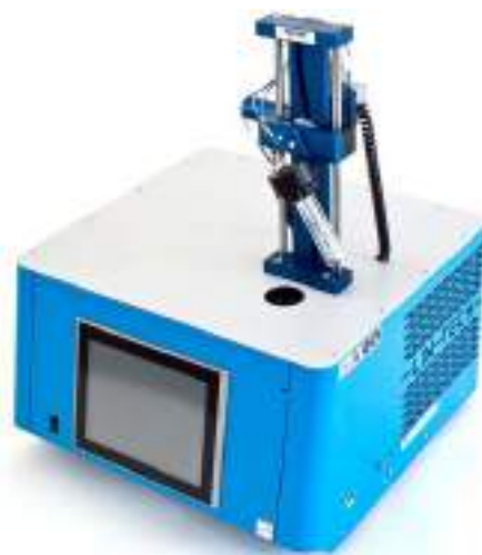
Рисунок 1- Аппарат NewLab 300 для определения температуры текучести нефти.
