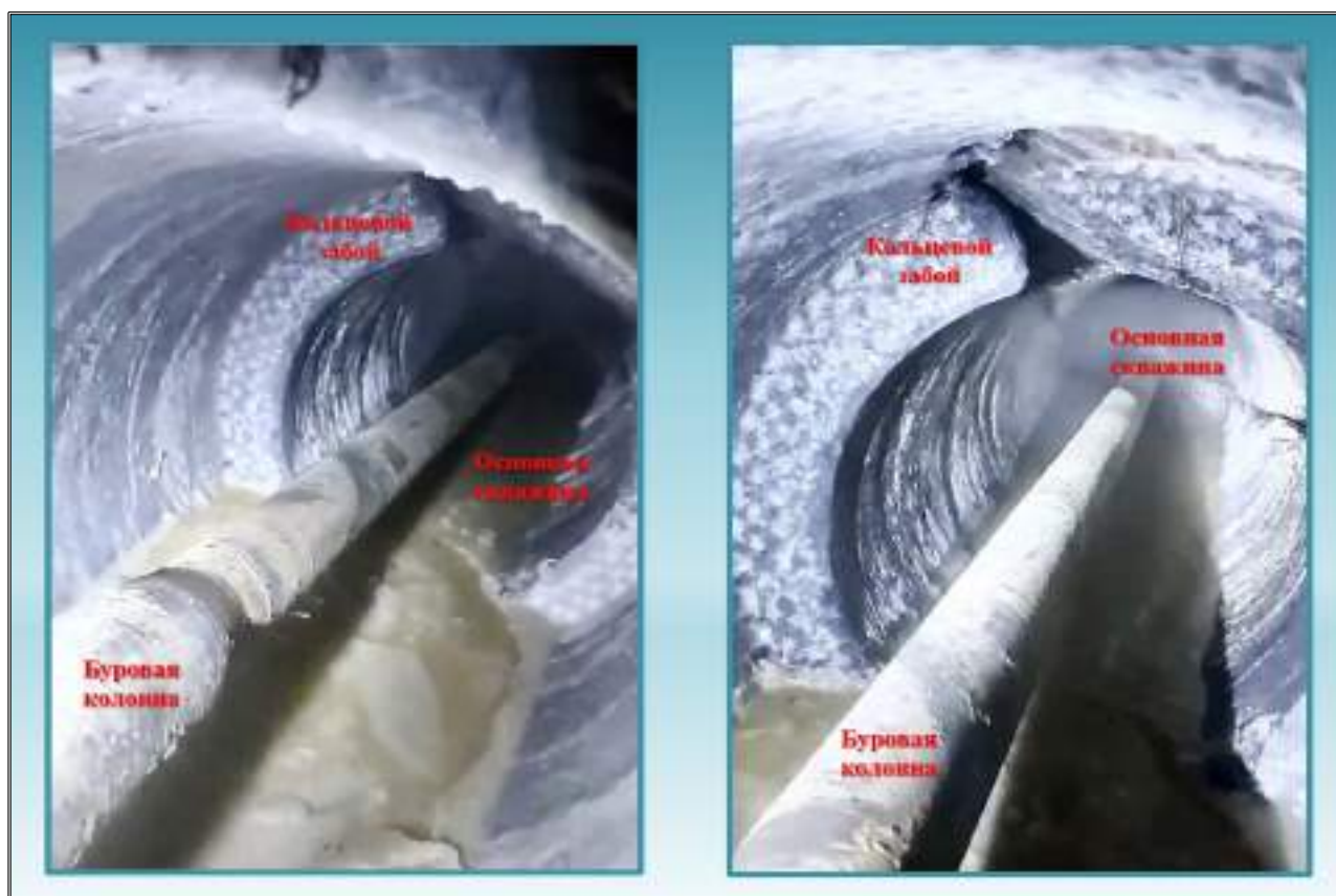
Рисунок 2 – Фотографии двух ракурсов разбуриваемого кольцевого забоя диаметром 555 мм в твердых породах при расширении пилотной скважины.
