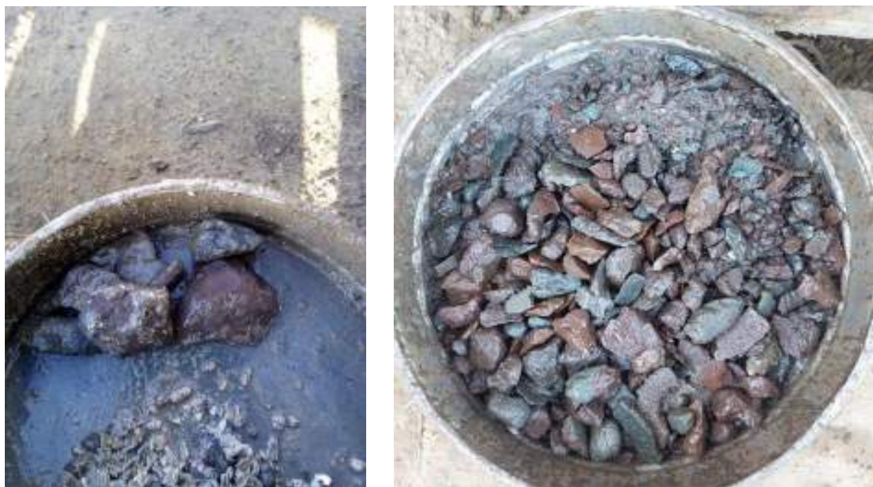
Рисунок 1 – Фото обвального шлама.
