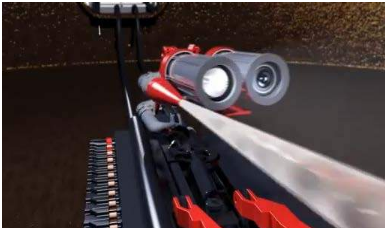
Рисунок 2 – Откачивающий насос и устройство для размыва отложений.
